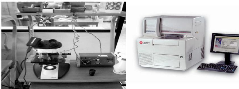
Figura 1. A) Equipo de electroforesis capilar montado en el laboratorio, B) Equipo comercial de EC.
