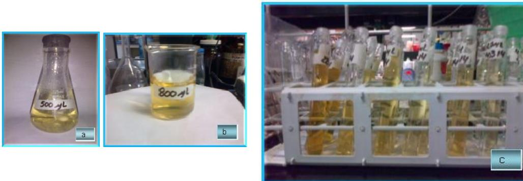
**Figura 1.** Técnica con citrato y diferentes concentraciones de  $\text{AgNO}_3$ . a) y b) solución de nanopartículas utilizando 0.45 y 0.5 mM de  $\text{AgNO}_3$  respectivamente, c) solución de nanopartículas con concentraciones de 0.2 mM a 0.45 mM de  $\text{AgNO}_3$ .
