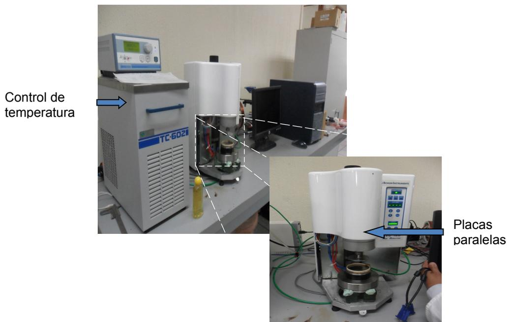
Figura 2. Reómetro rotacional Bohlin CVO 120. Detalle de las placas paralelas (plato-plato).
