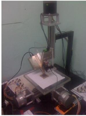
Figura 3. Sistema de escaneo de rayos X.
