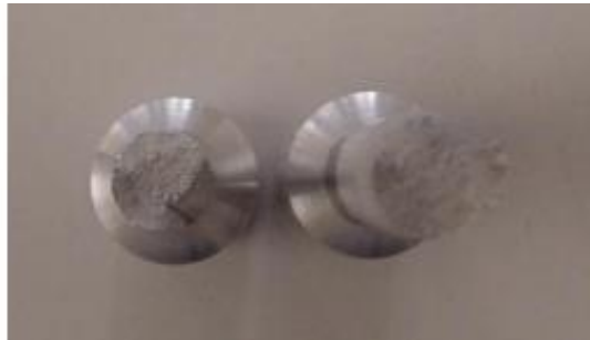
Figura. 4 Rotura de Probeta al realizar prueba de tensión
