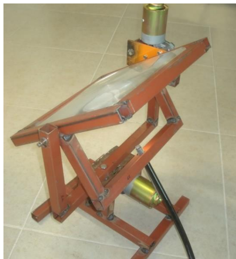
Figura 4 Sistema fabricado, Seguidor solar con fibra óptica y lente
