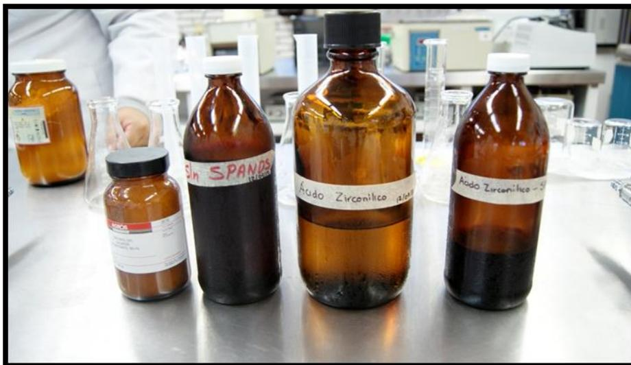
Figura 1. Reactivos: Sal trisódica SPANDS, Oxiclورو de zirconio IV octahidratado y Ácido zirconílico.
