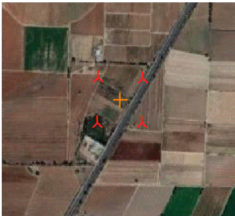
Figura 7: Vista aérea del sitio con el arreglo de aerogeneradores (rojo) y la estación de medición (naranja).
