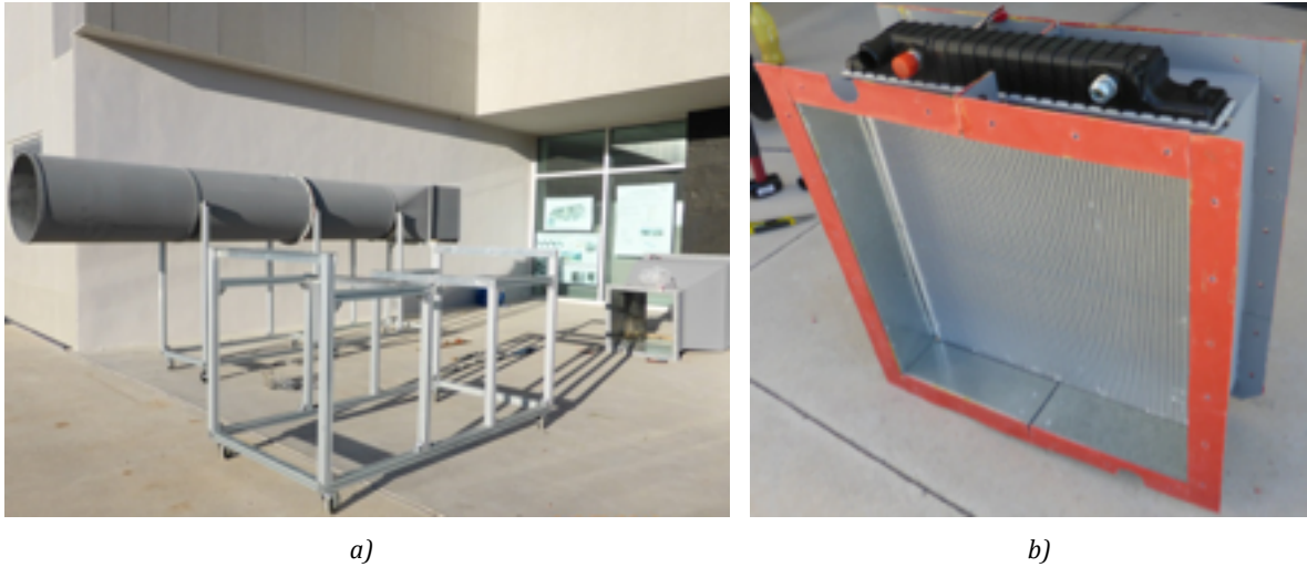
Figura 8. a) Túnel de viento sobre los soportes, b) ICA en soporte.
