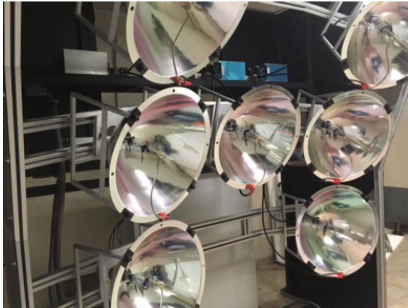
Figura 1. Simulador Solar de Alto Flujo de 17.5 kWe desarrollado en el CIO-Aguascalientes [11].
