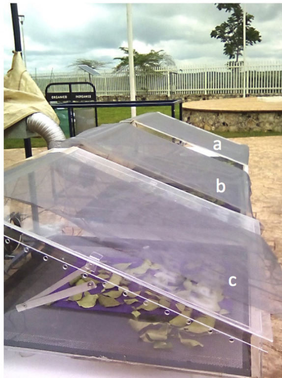
Figura 5. Gabinetes de secado solar con malla sombra en la parte superior: a) convección natural, b) prototipo, c) convección forzada.
