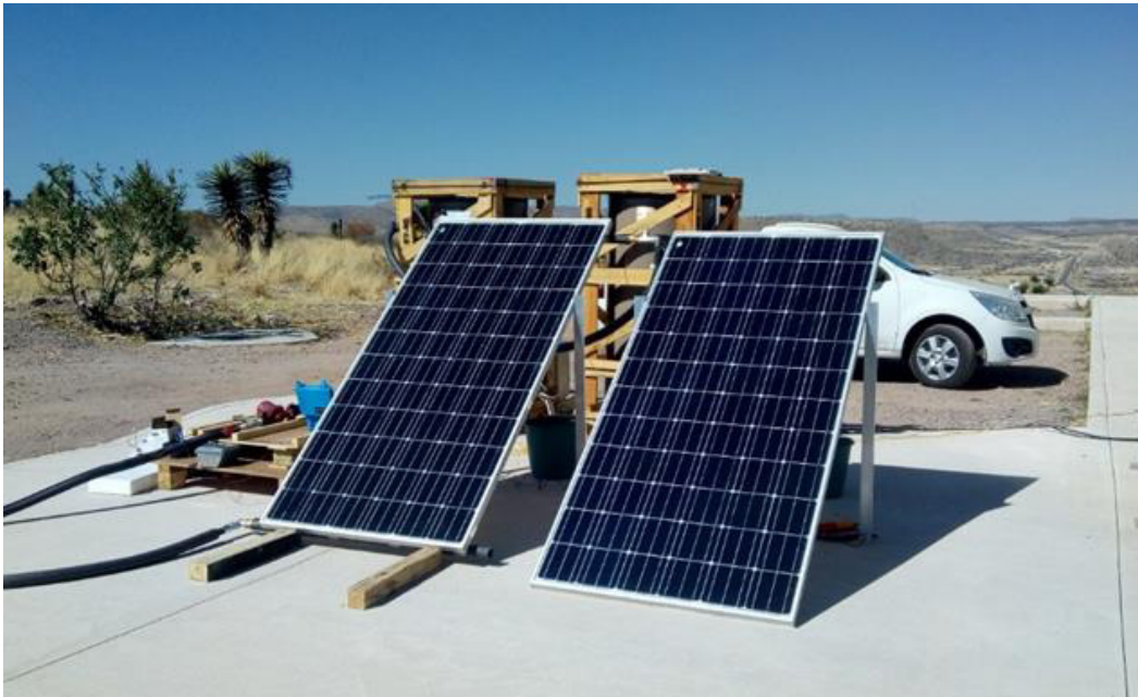
Figura 4. Evaluación experimental del colector FV-T y módulo FV de referencia.
