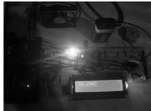
Figure 5 Circuito final funcionando, sensor de temperatura DHT11
