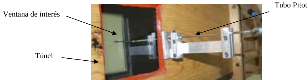
Figura 1. Medición del perfil del flujo en la sección de trabajo de un túnel de viento usando un tubo Pitot.
