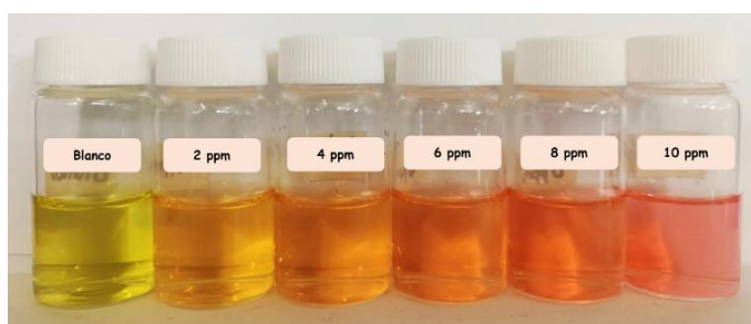
Figura 3. Curva de calibración de complejo PAR-Pb.
