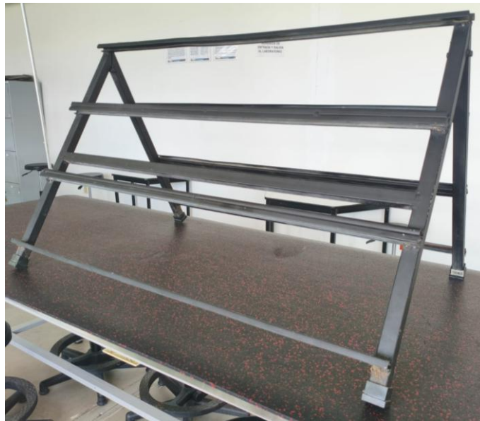
Figura 1. Bases para montaje de paneles.
