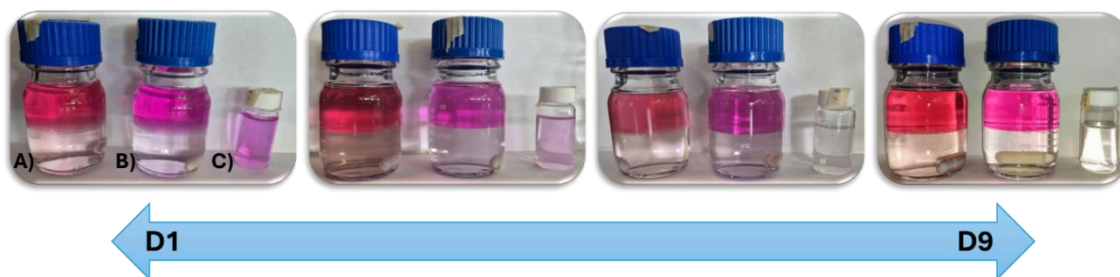
Figura 3. Evolución de la coloración de la fenolftaleína (PhPh) en A) PEG-1000/citrato de sodio, B) PEG-1000/sulfato de sodio y C) NaOH 0.05 M a lo largo del tiempo.
