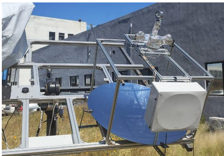
Figura 1 . Sistema solar hidrotermal, compuesto de un reactor de acero inoxidable fijado sobre una base en perfil de aluminio montado sobre un seguidor solar en dos ejes.
