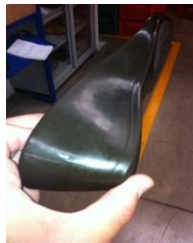
Figura 1: Ubicación de los defectos en la suela.
