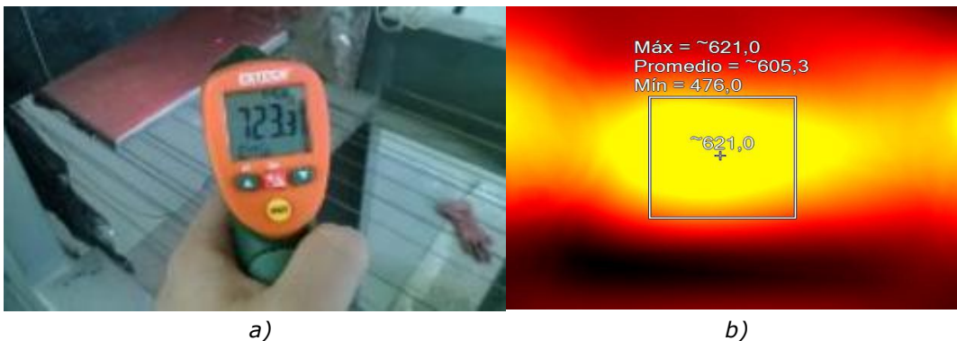
Figura 3. 4: Resultados experimentales estado estacionario de temperatura superficial (Fecha de elaboración: 20/02/2015)
